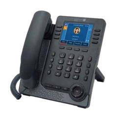
M7桌面话机配备两个USB接口(TYPE A/C),极大地扩展了M7的功能,使其不仅仅是个单纯的话机还可以连接外部设备进行扩展,如扩展模块(EM20或EM200)、耳机、会议模块等;M7支持音频转接功能(Audio Hub ),可连接PC作为外部扬声器,从而享受超宽带音频效果;M7桌面话机通过USB可连接Wi-Fi 外接模块,转变成为Wi-Fi 桌面电话。
