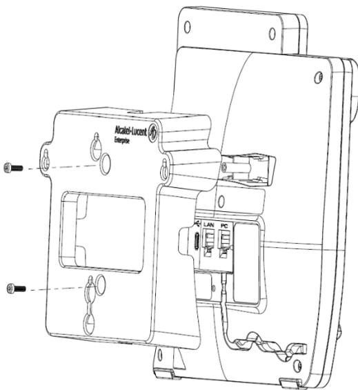
**2** Hängen Sie das montierte Telefon mit dem Wandmontagesatz an die Wandplatte.
