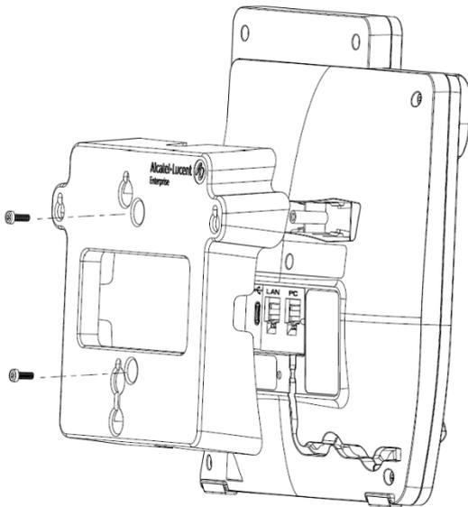
**2** Appendere il telefono montato con il kit di montaggio a parete sulla piastra.
