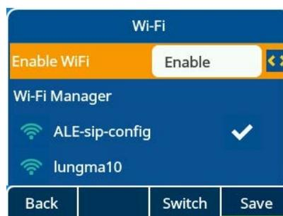
2. Quando il cursore si sposta su una rete wireless, premere il tasto **Dettagli** per visualizzare le informazioni dettagliate sulla rete, come l'SSID, la modalità di crittografia e il canale di trasmissione.
